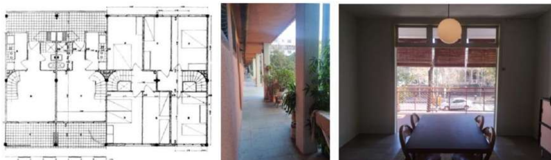
Fig. 5. Casa Bloc (1936-39). Relación exterior interior: ampliación de las viviendas a través de balcones y espacios colectivos comunes. Fuente: Freixa, J. (1979). Josep Lluís Sert. Barcelona: Gustavo Gili. Pág.44. Fotografías de los autores.
