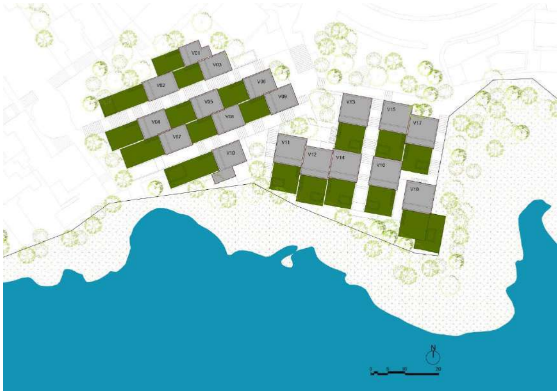
FIGURA 05. Encaje esquemático de las viviendas en el solar utilizando como base la cartografía actual. Se interpreta la situación original enfatizando la concepción modular del proyecto. Dibujo de los autores.
